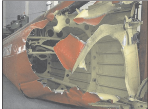
Figura 1.16.7.3. Zona de rotura del cono de cola
