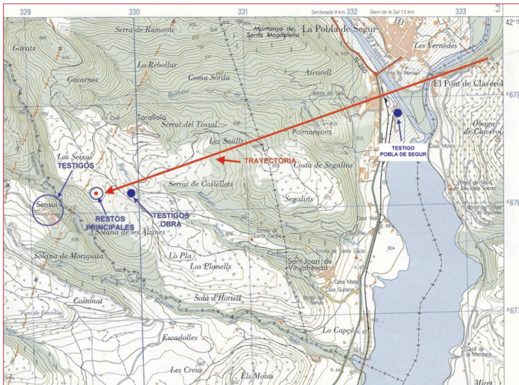
Figura 1.18.1. Trayectoria final del helicóptero y situación de testigos
