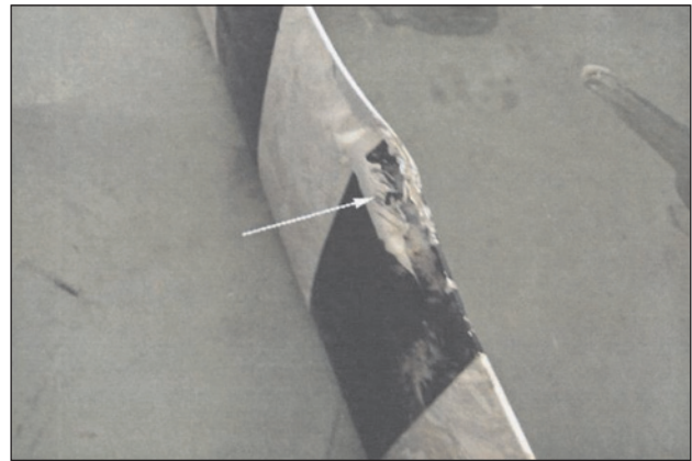
Figura 1.16.4.4. Detalle del golpe que presentaba la pala desmontada
