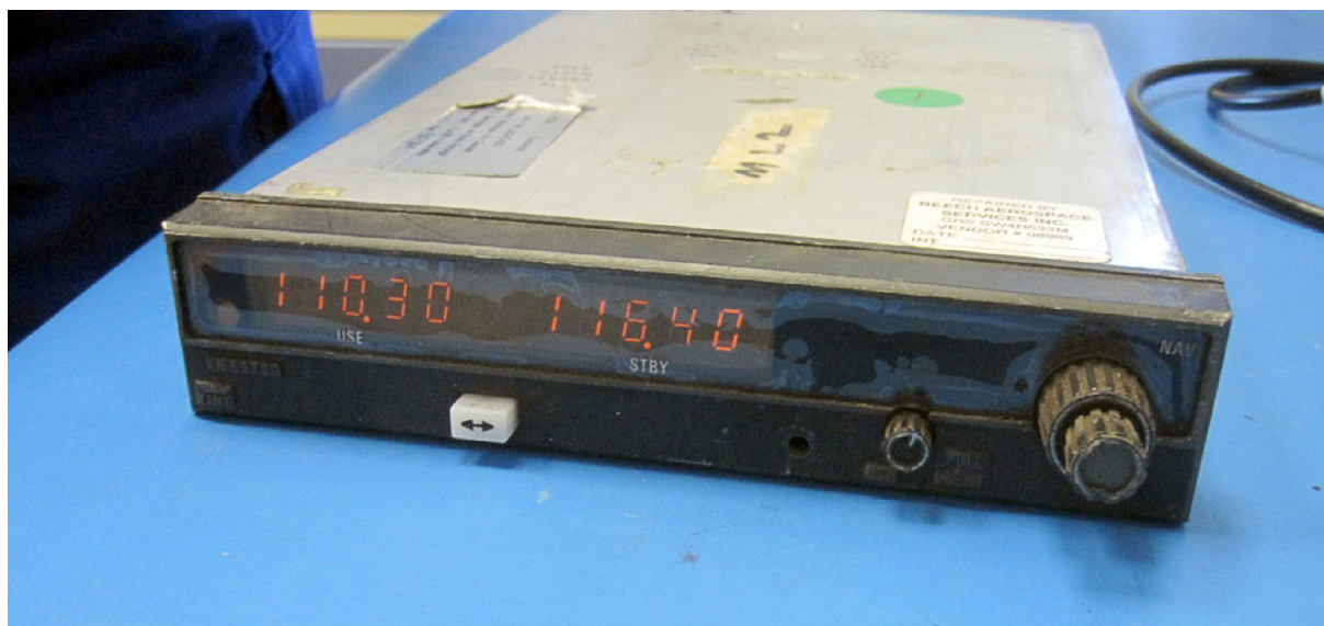
Figura 9. Frecuencias seleccionadas en el NAV1 (comandante)
