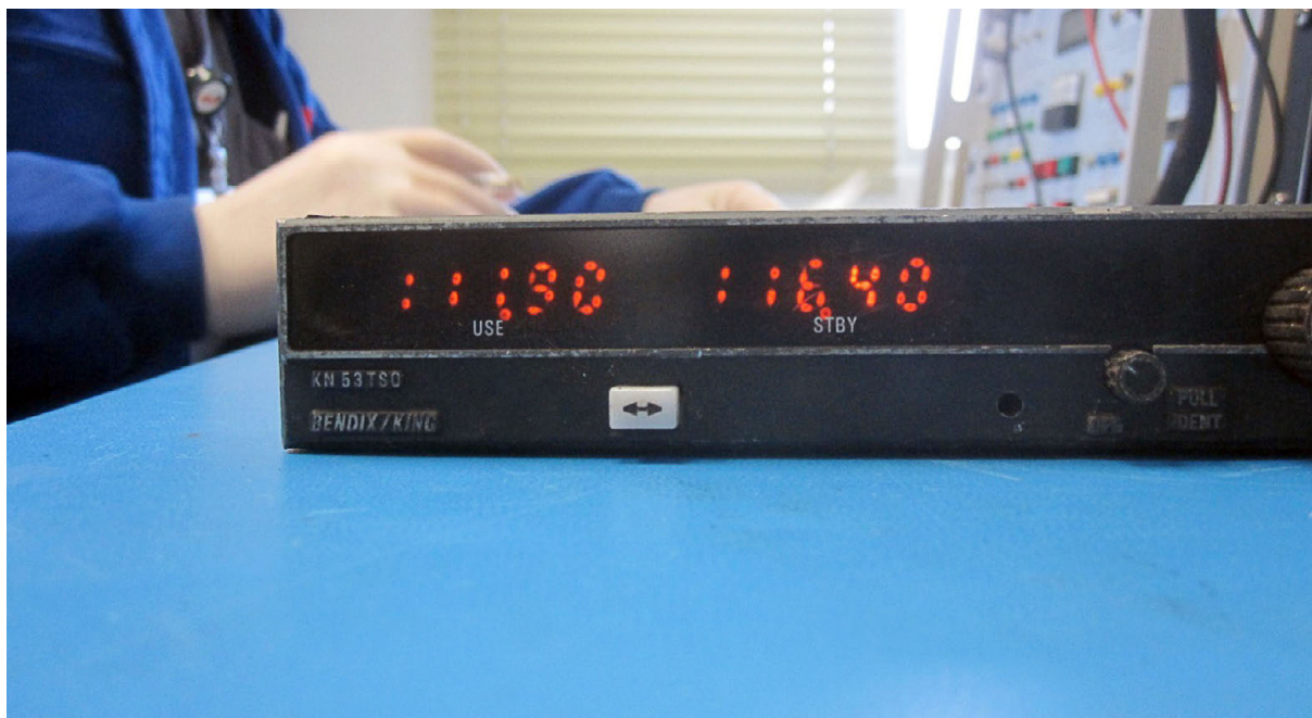
Figura 10. Frecuencias seleccionadas en el NAV2 (copiloto)
