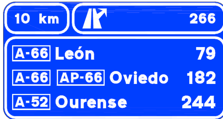
Nuevo cartel de pre-señalización de salida hacia capitales de provincia
