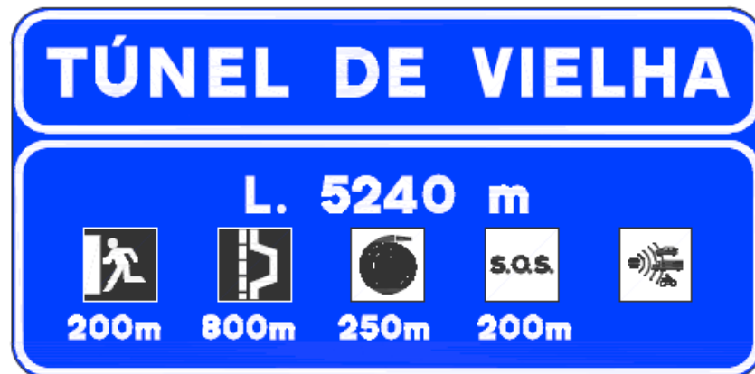
Cartel de señalación de túnel con indicación de los elementos de seguridad disponibles
