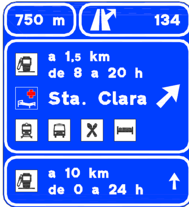
Nuevos carteles de salida hacia estaciones de servicio y otros servicios adyacentes a la carretera
