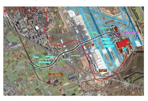
El túnel, con un diámetro de 10,6 m y una profundidad máxima de 25,8 m, tendrá una longitud de 1.364 m en su primer tramo, que se extiende hasta la estación intermodal que se situará en la terminal T2, y 1.466 m desde ésta hasta la T1, tras discurrir bajo pistas.
