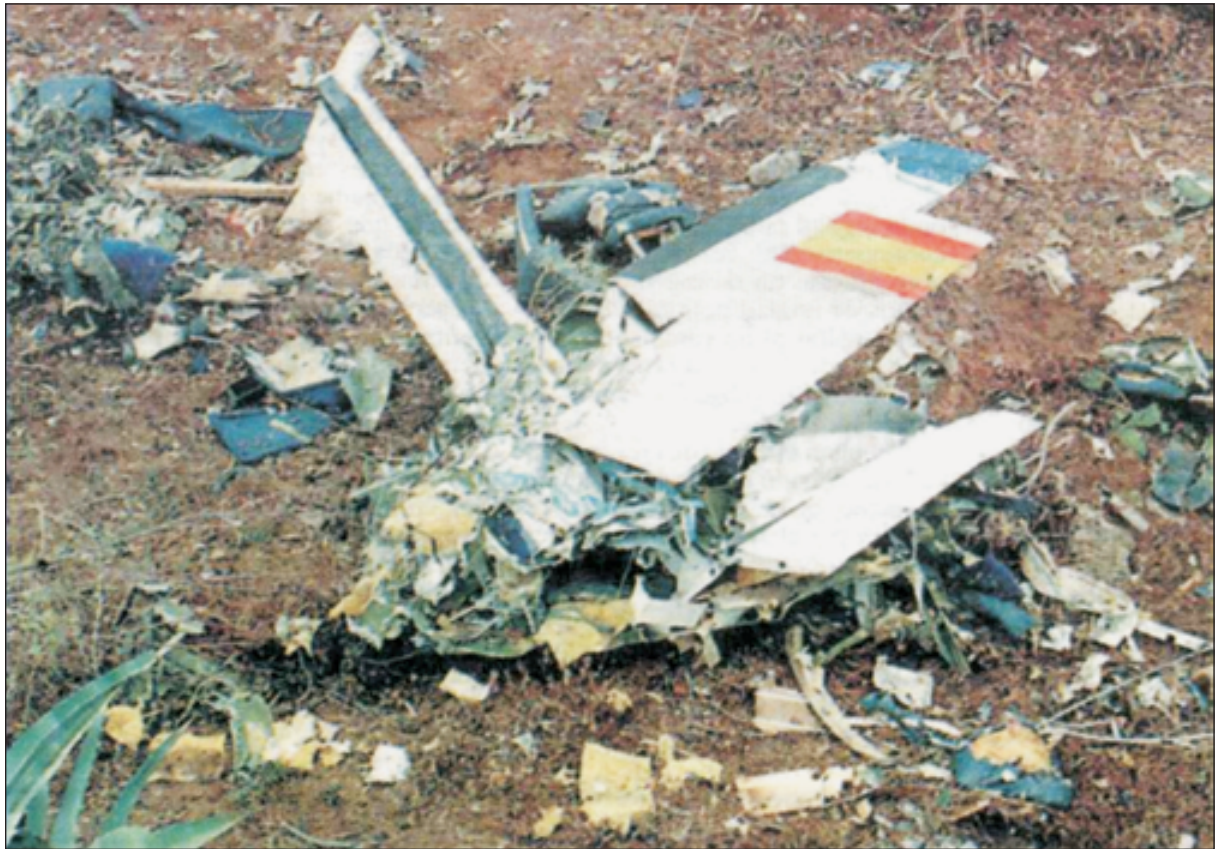
Foto 3. Restos de fuselaje y empenaje de cola
