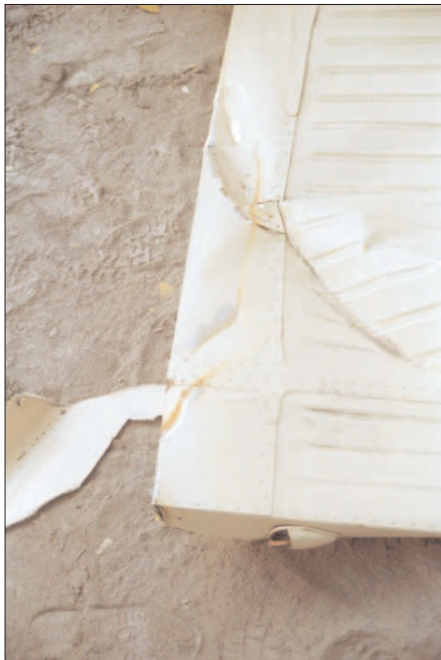
Detalle 3. Daños en el estabilizador
