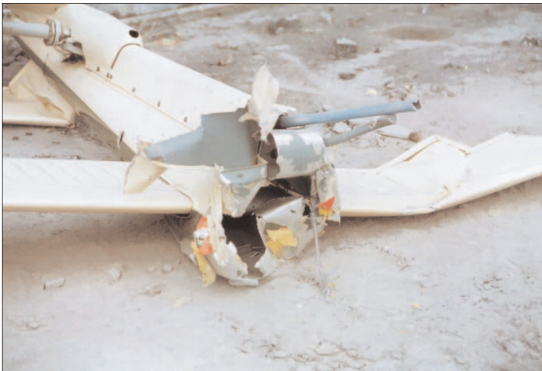
Foto 4. Detalle conjunto de cola (obsérvese corte y desgarro de revestimientos de abajo hacia arriba)
