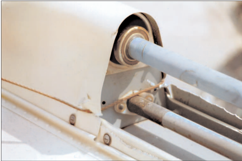
Detalle 4. Eje de transmisión y barra de mando del rotor antipar. Posición del cable
