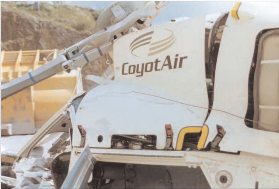
Detalle 1. Cable enrollado sobre la cabina
