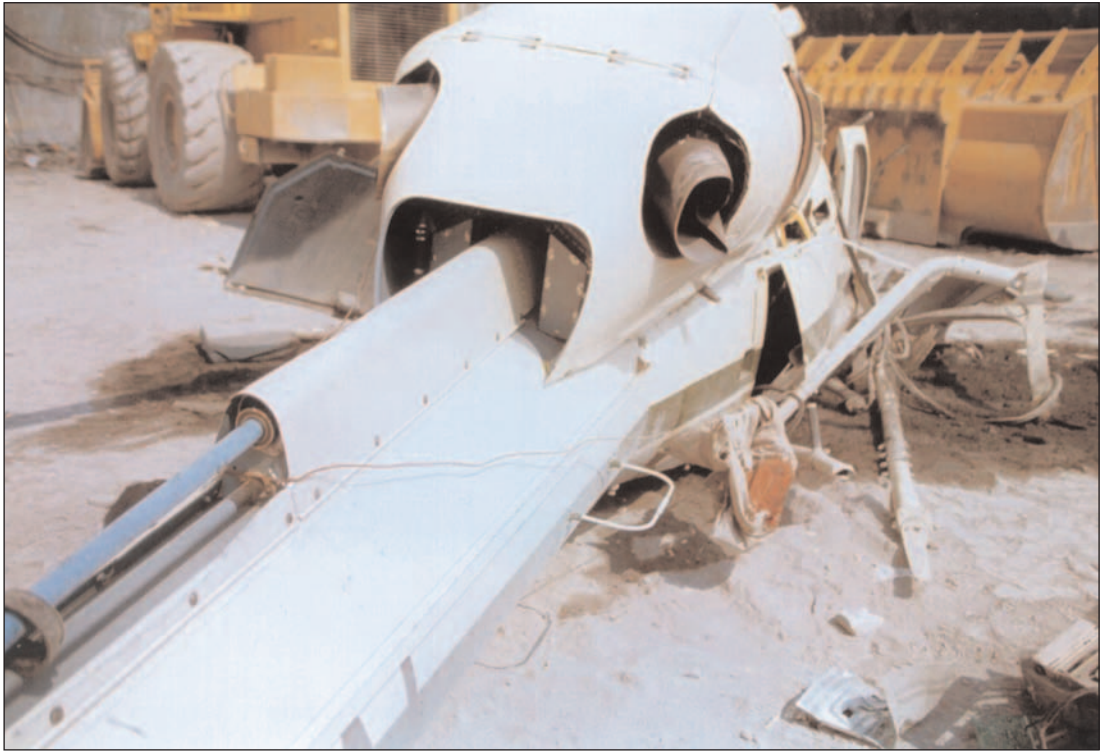
Foto 5. Fuselaje posterior (obsérvese cable y tobera chafada)
