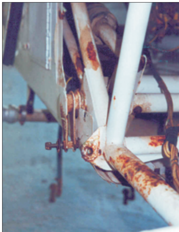
Foto 2. Detalle del estado corrosión de la aeronave
