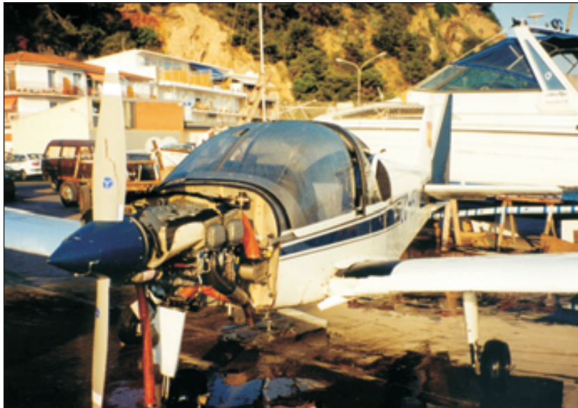
Fotografía 2. Daños en la hélice
