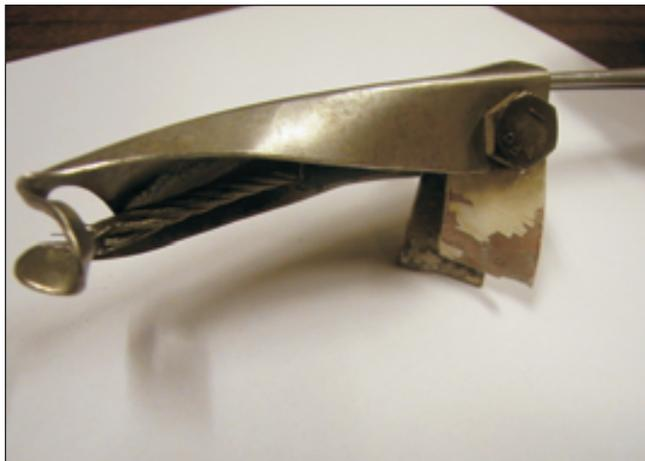
e) Para producirse la interferencia del hilo eléctrico con la deriva se tuvo que romper el salvacables previamente, o bien se originó la rotura de alguna de las sujeciones de la base de la deriva al fuselaje, iniciándose así el desprendimiento del estabilizador vertical.
