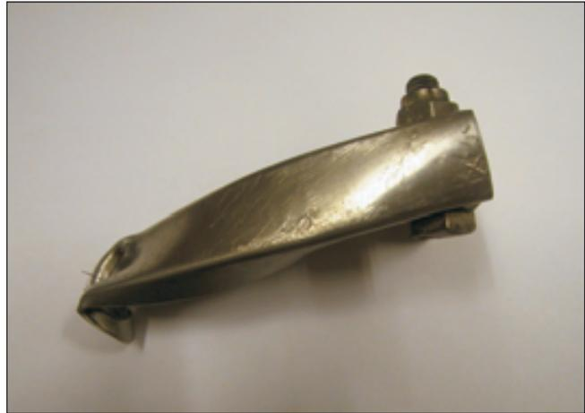
d) La chapa del extremo del cable desviacables se deformó de forma coherente con la deformación que mostraba el borde de ataque de la deriva. La unión chapa-deriva se rompió por torsión, de acuerdo también con las deformaciones anteriores.
