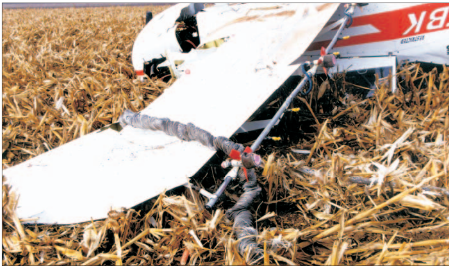
Figura 3. Cable enroscado en el plano derecho de la aeronave
