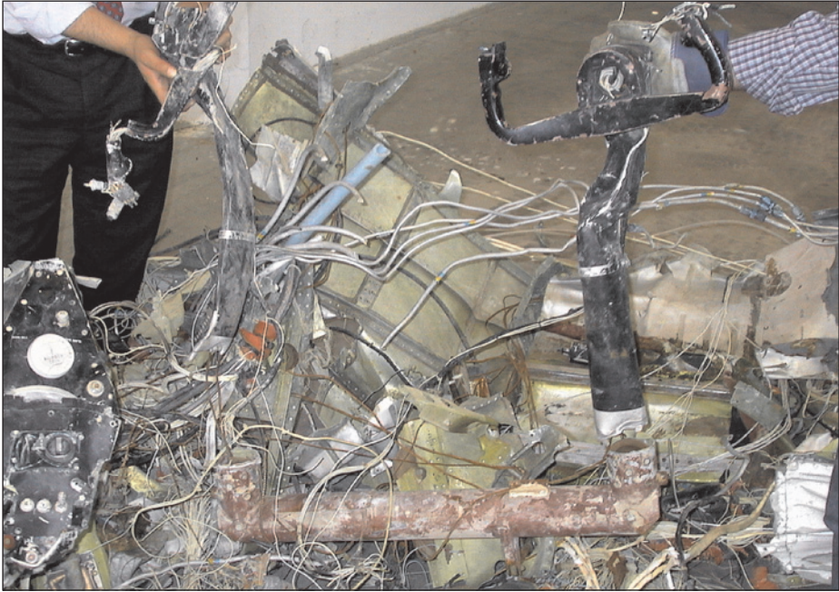
Figura C-4. Restos de las columnas y las barras de mando
