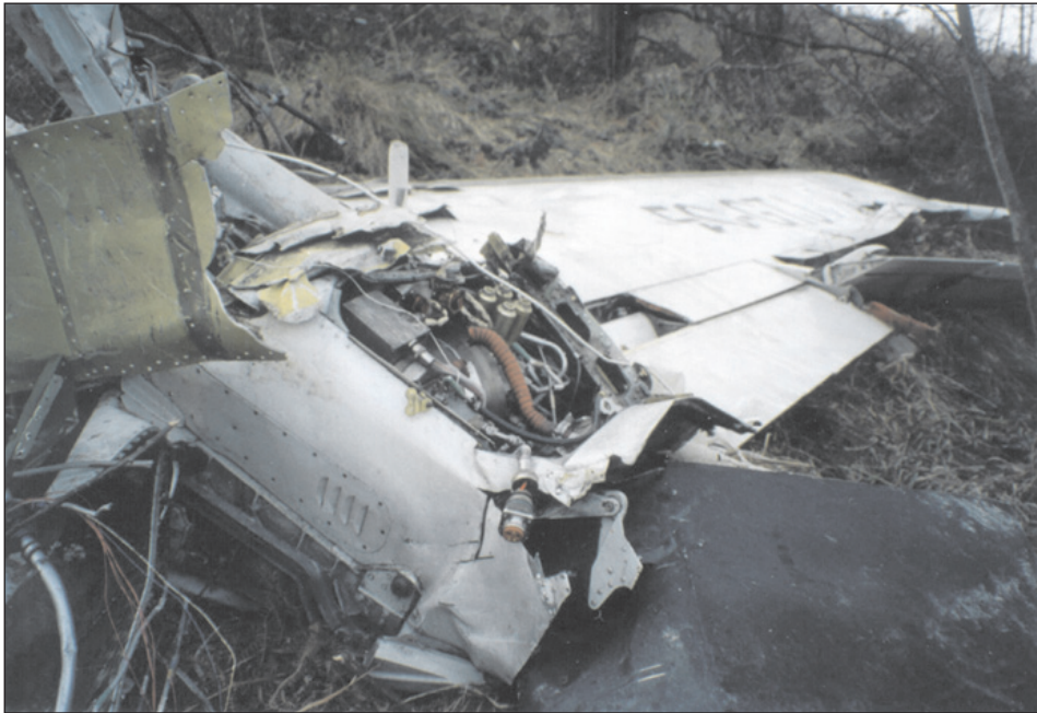
Figura 1.12.5. Ala y motor derechos
