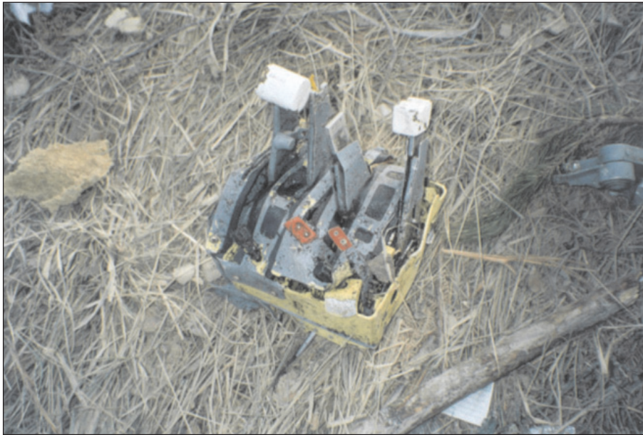
Figura 1.16.2. Pedestal con los mandos de los motores
