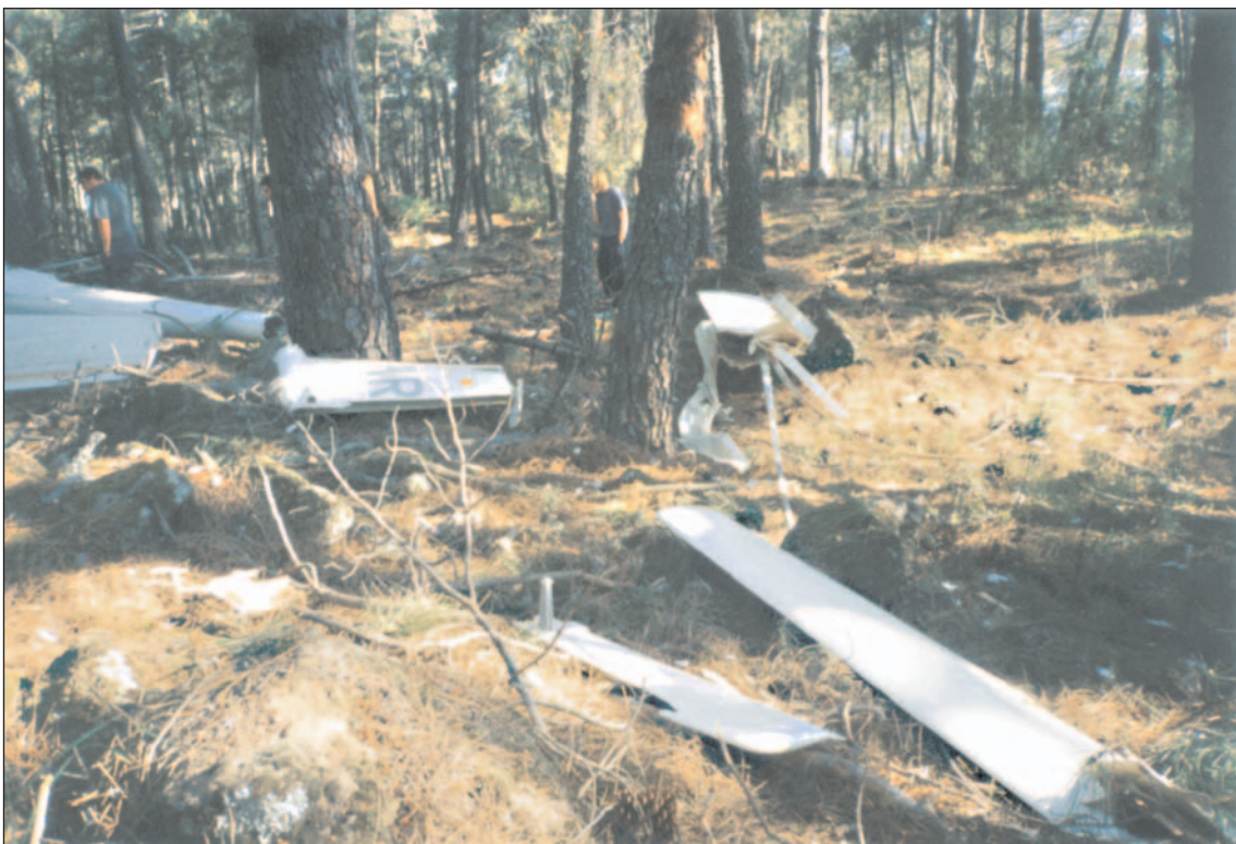
Figura A-4. Restos de estabilizador y fuselaje posterior
