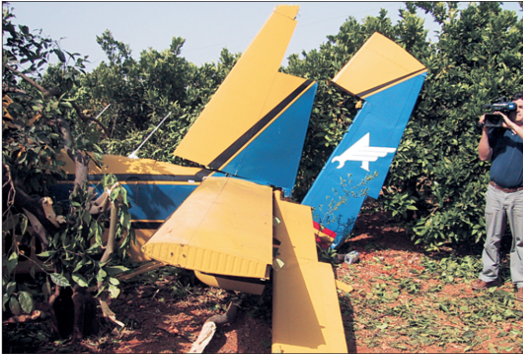
Foto 3. Timón de dirección y de profundidad desprendidos
