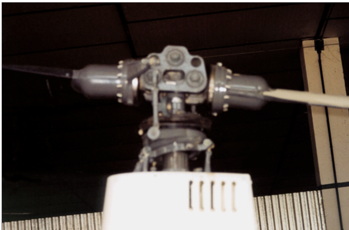
Foto 2. Cabeza del rotor principal
