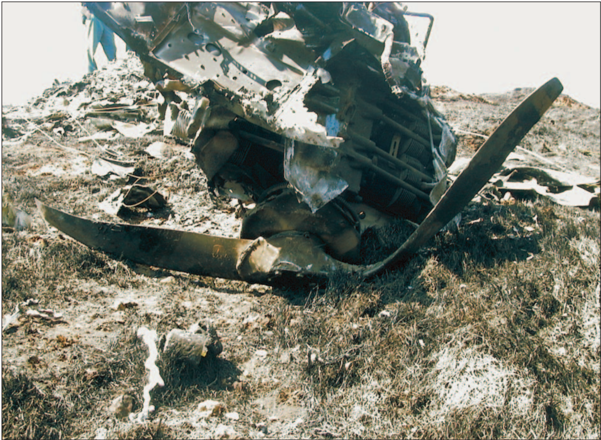
Foto B-2. Restos del grupo motopropulsor
