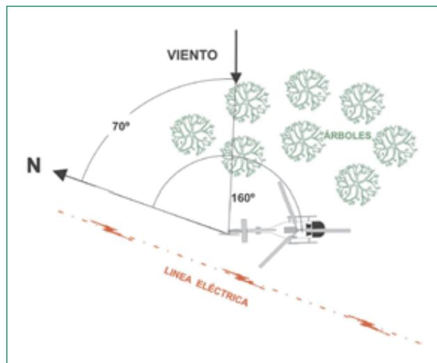
En estas condiciones, el piloto declara que inició un ascenso muy lento desde estacionario, sin ningún desplazamiento horizontal, durante aproximadamente 10 segundos aplicando potencia máxima (hacia 20 minutos que el helicóptero había repostado y transportaba 6 bomberos), colectivo para ascender y ligero pedal izquierdo (para compensar el efecto del viento de costado).
