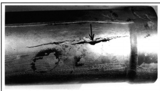
Fig. 8.- Detalle de la rotura de la pieza
