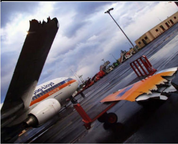
Figura 1.- Daños en la aeronave D-AHFV
