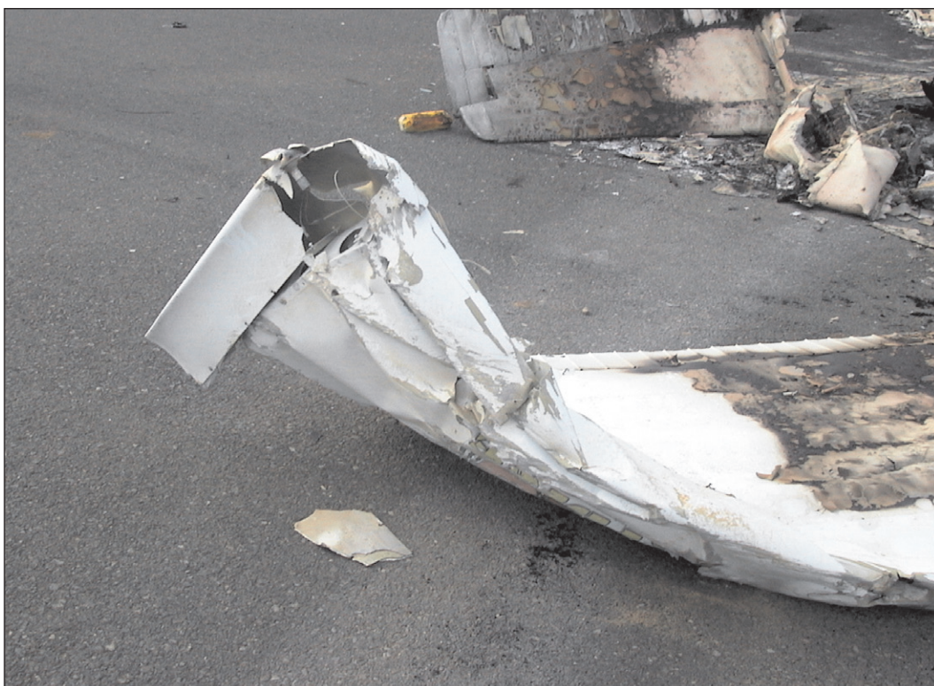
Daños en el extremo del ala derecha
