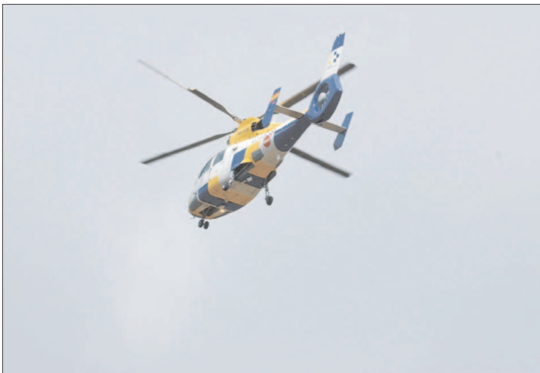
Figura 1.1.3. El helicóptero volando poco después del impacto con los cables. La mayor parte de la cuerda de la pala estaba desaparecida aproximadamente en media envergadura (foto La Provincia )
