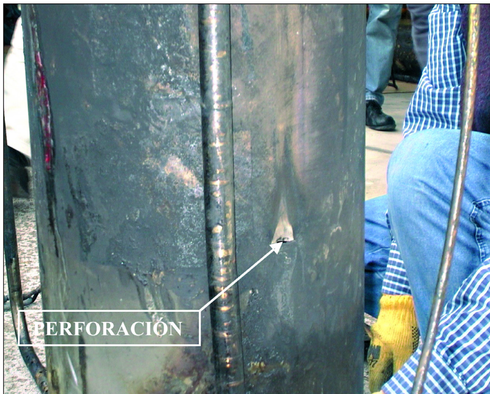
Figura 7. Perforación en la botella de propano
