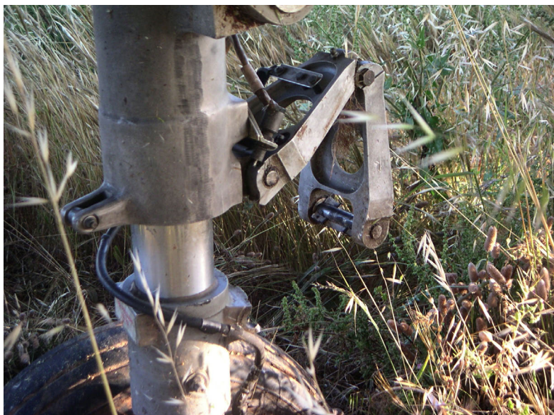
Foto 3. Pata principal derecha. Rotura de la tijera de torsión
