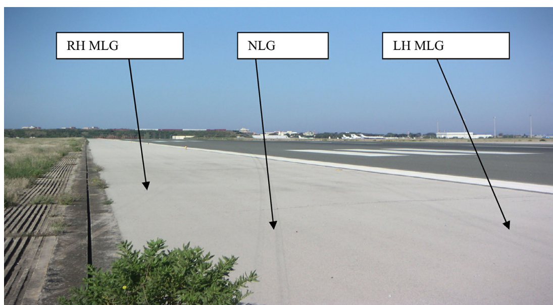
Foto 1. Marcas de las ruedas del tren sobre la pista
