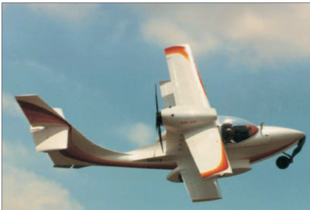
Foto 1.6.4.1. Vista de un avión similar (foto obtenida del fabricante del kit). Se aprecia la tapa del pozo del tren de morro
