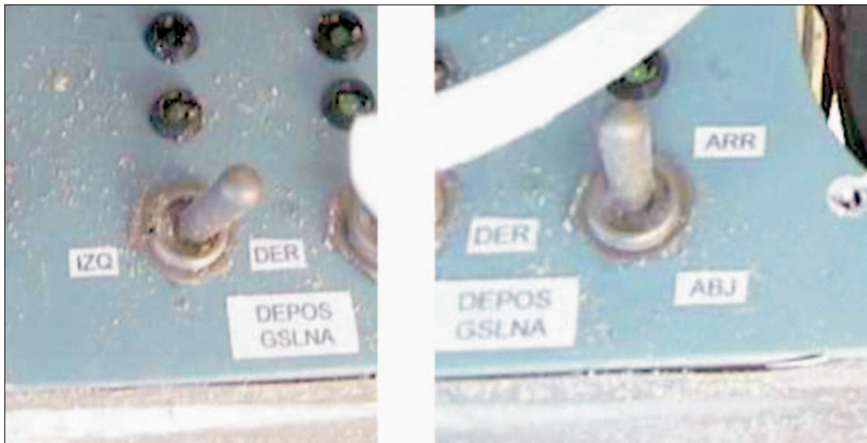
Foto 1.6.4.4. Tras el accidente, en el panel de mandos aparecía seleccionado el depósito de combustible superior derecho
