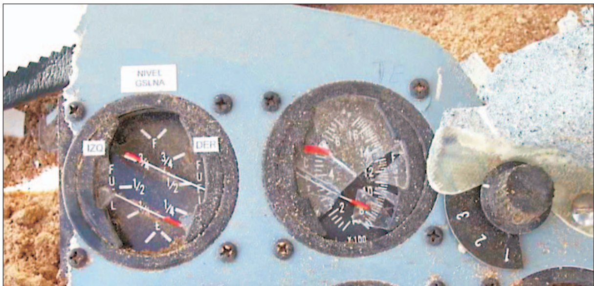
Foto 1.6.4.5. Estado del indicador de combustible (marcado con el rótulo «NIVEL GSLNA») tras el accidente. Como el interruptor de selección de depósitos estaba en «arriba», si el indicador estuviese funcionando todavía correctamente, a la izquierda marcaría que el depósito superior izquierdo tenía 3/4 de capacidad y a la derecha que el depósito superior derecho estaba casi vacío
