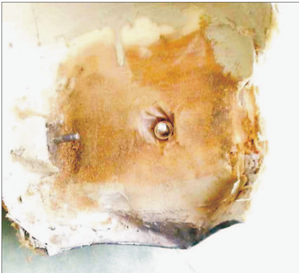
Foto 1.16.2.1. Vista interior del cono de morro del avión. Se aprecia el tornillo de sujeción de la tapa del pozo del tren de morro (izquierda de la foto) sin daños en su rosca. El otro tornillo ha desaparecido (lado derecho de la foto). El tornillo central corresponde a la arandela de sujeción situada en el vértice delantero del avión
