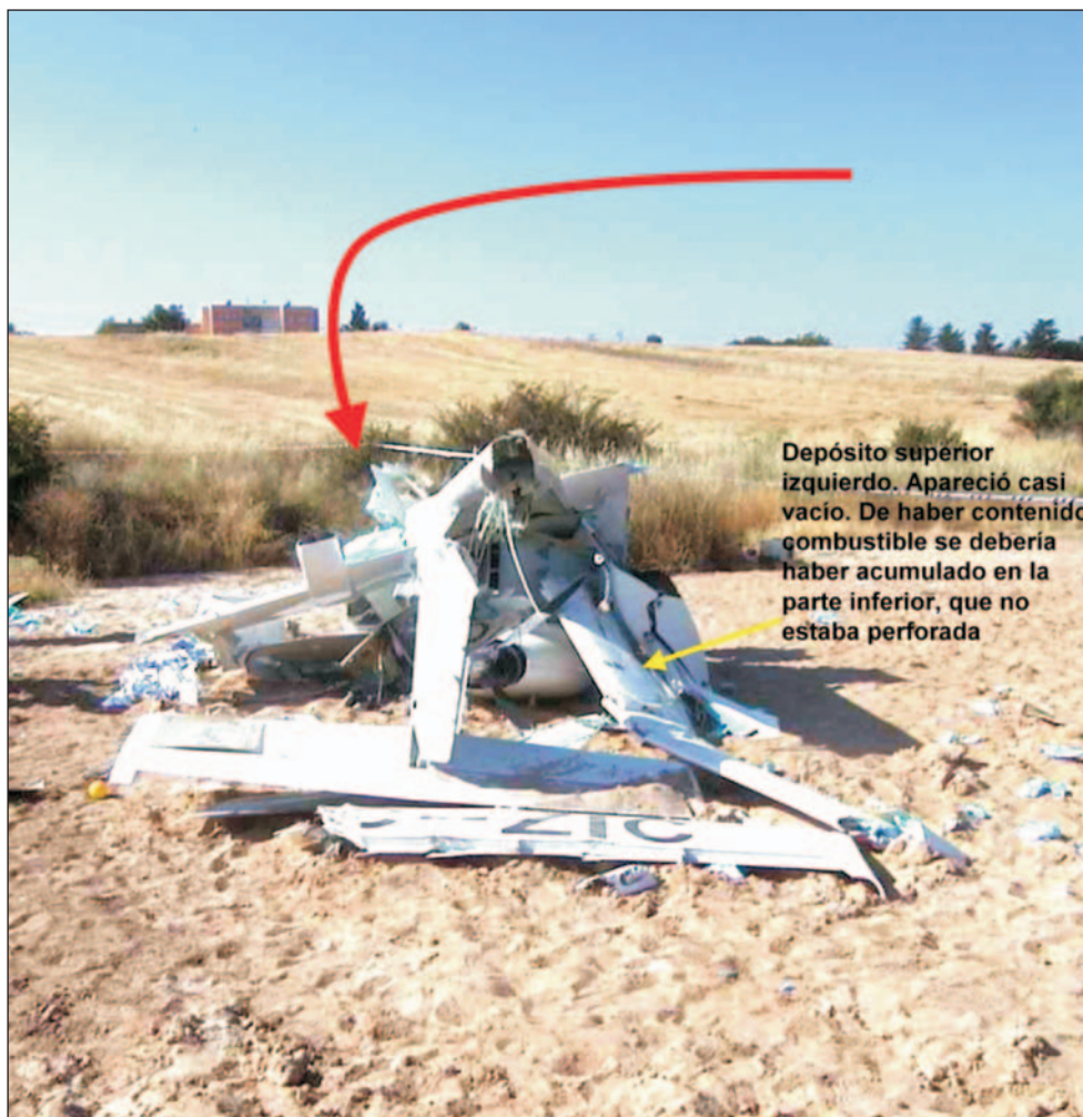
Foto 1.12.1. Posición de los restos vistos en sentido inverso al vuelo. Los estabilizadores y el motor han quedado en la parte delantera porque el avión capotó. En rojo se marca una posible trayectoria final de la aeronave según la declaración de testigos
