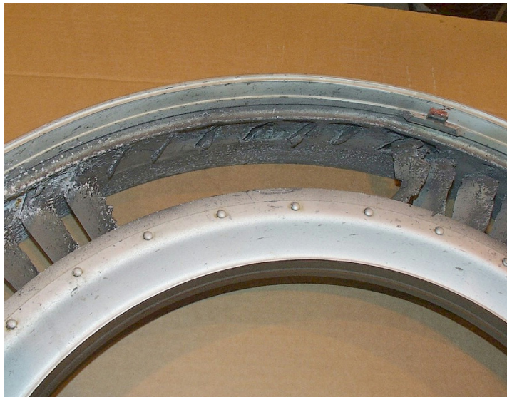
Figura 10. Estator de la etapa 8 del HPC
