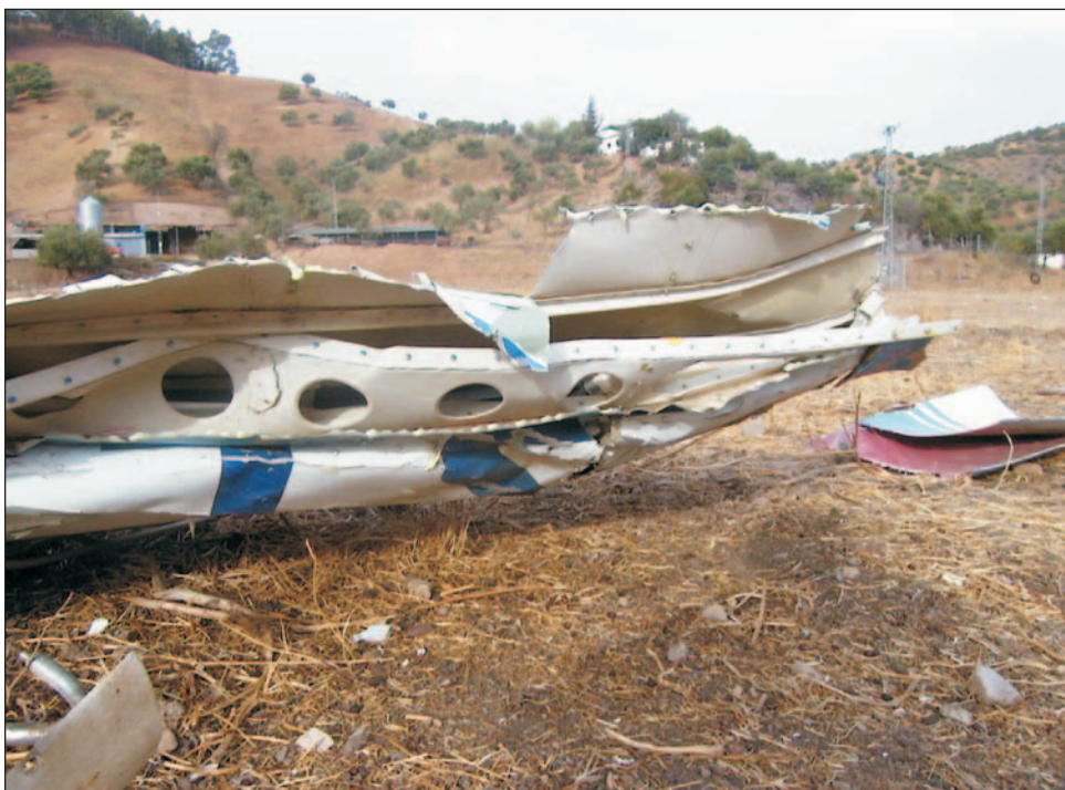
Foto 5. Deformaciones producidas por el cable en el plano izquierdo
