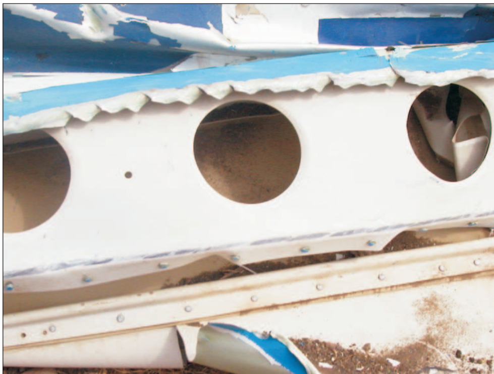
Foto 4. Detalle de las marcas dejadas por el cable en el plano izquierdo
