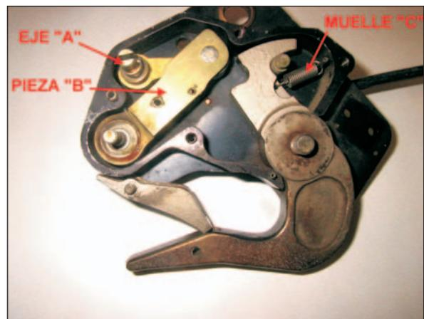
Figura 5. Gancho de carga en posición «desbloqueado»
