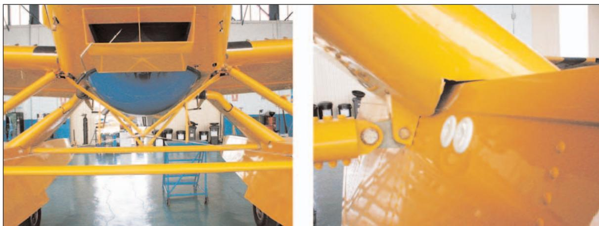
Figuras 3 y 4. Montantes y detalle de la rotura del montante
