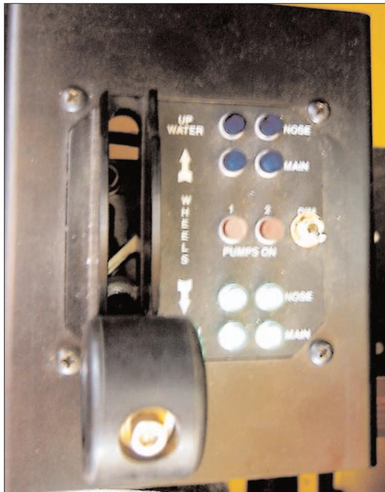
Figura 8. Indicación de tren en cabina
