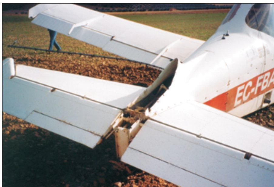
Foto 1. Zona de rotura del empenaje vertical
