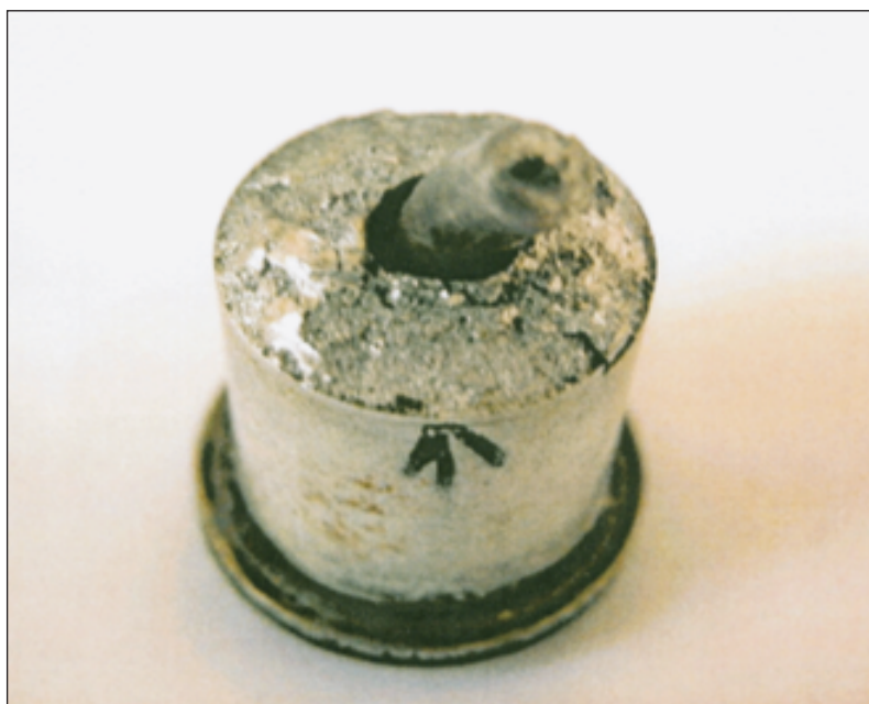
Foto 1. Detalle de la rotura del tetón
