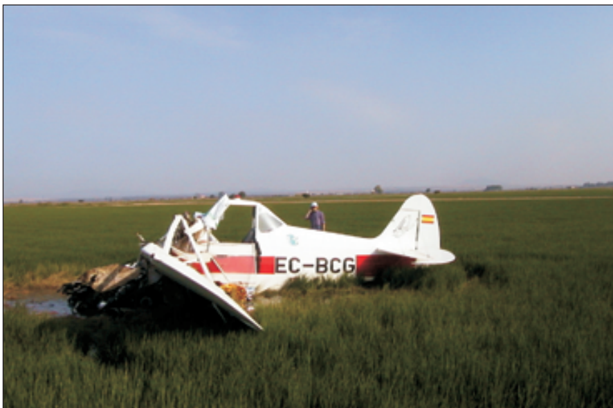
Foto 1. Tanques destruidos y plano girado
