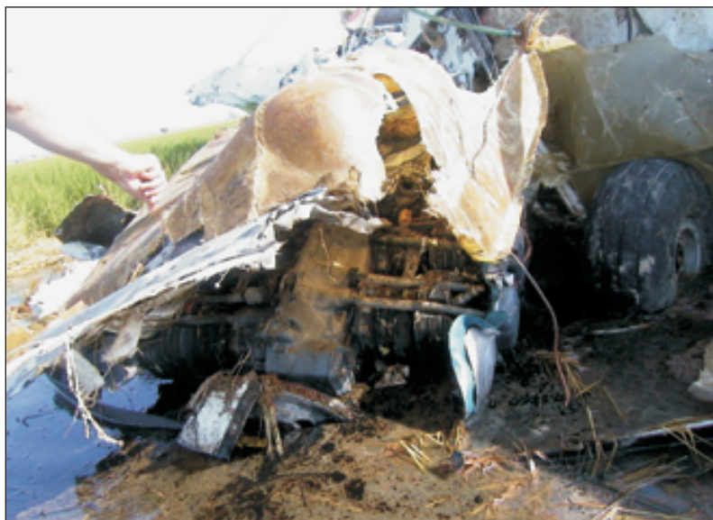
Foto 3. Daños en el motor y hélice
