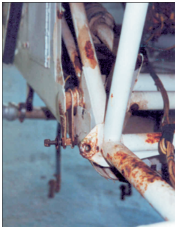
Foto 2. Detalle del estado corrosión de la aeronave
