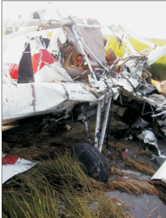
Foto 2. Daños en el tren principal
