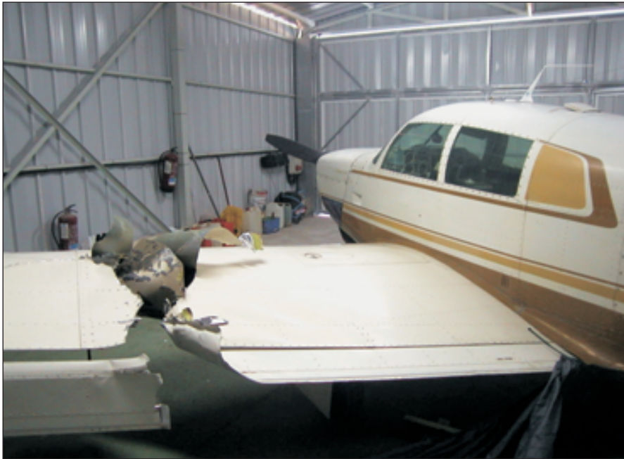
Foto 1. Daños ocasionados en el ala izquierda de la aeronave D-EIGB
