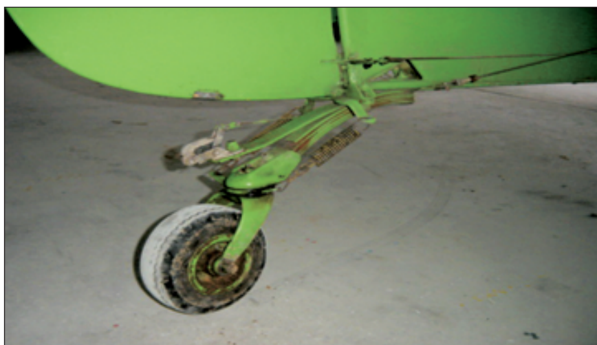
Figura 3. Patín de cola. Posición normal
