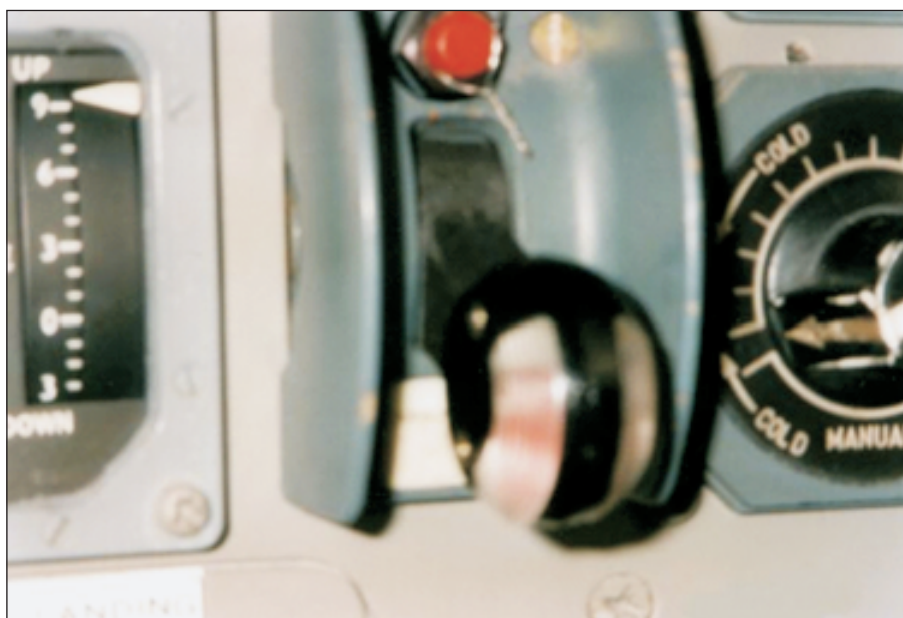
Photo 3. Landing gear lever and «crash button»
