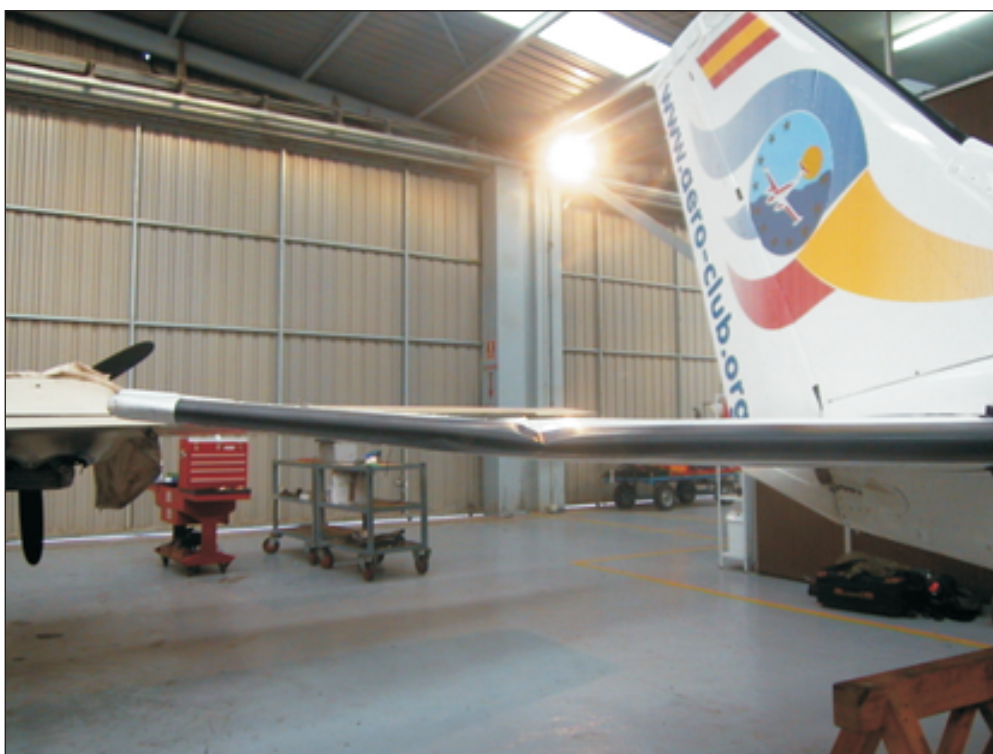
Foto 1. Daños en el estabilizador horizontal
