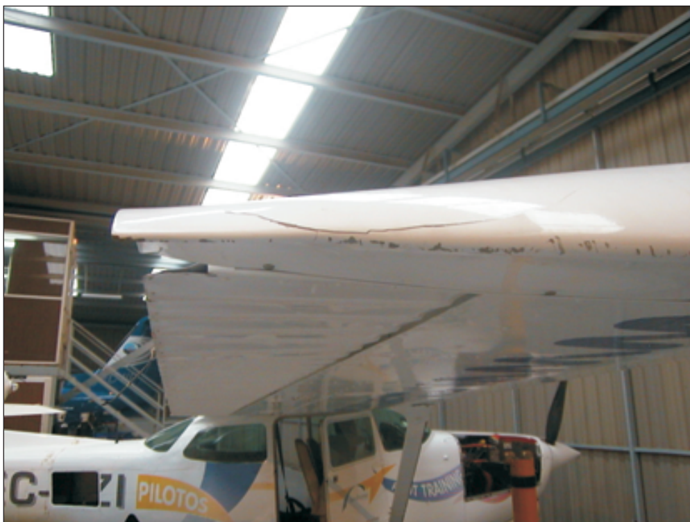
Foto 2. Daños en la punta de ala
