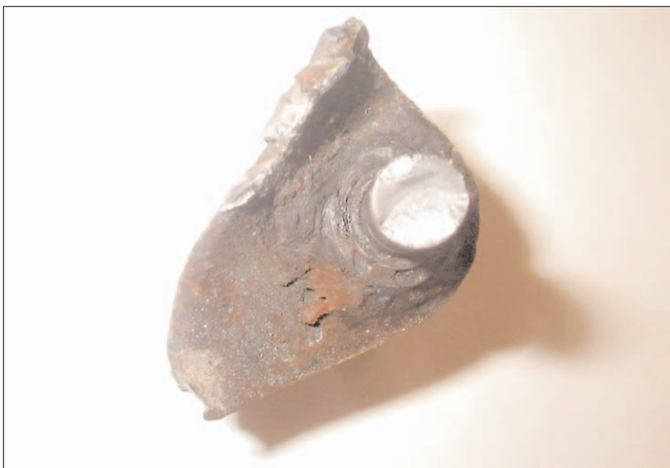
Foto 4. Vista general de la cara de fractura del tornillo AN6-43
