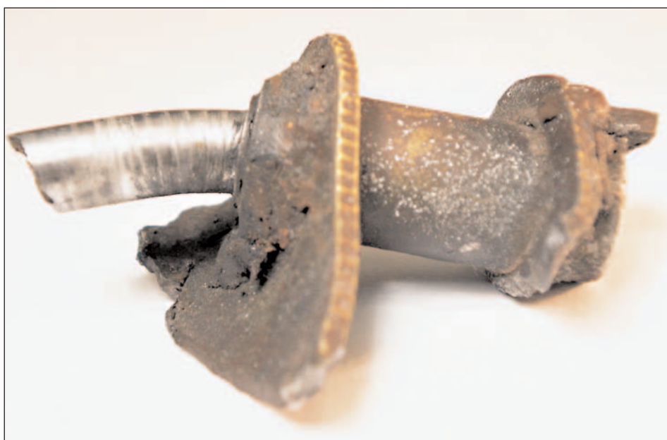
Foto 3. Parte de la cabeza del tornillo AN6-43 y del herraje derecho
