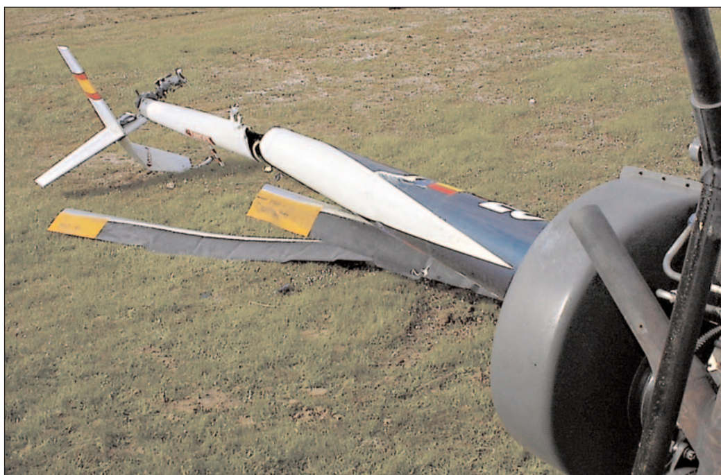
Foto 2. Desperfectos en el mástil y palas del rotor
