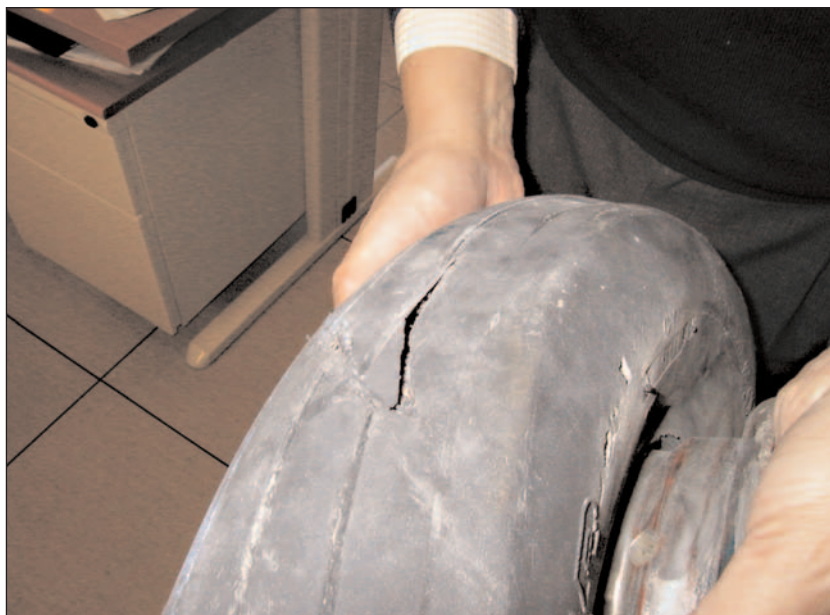
Figura 5. Daño en la zona central de la cubierta
