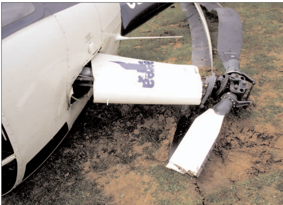
Foto 1. Desperfectos en el mástil y palas del rotor
