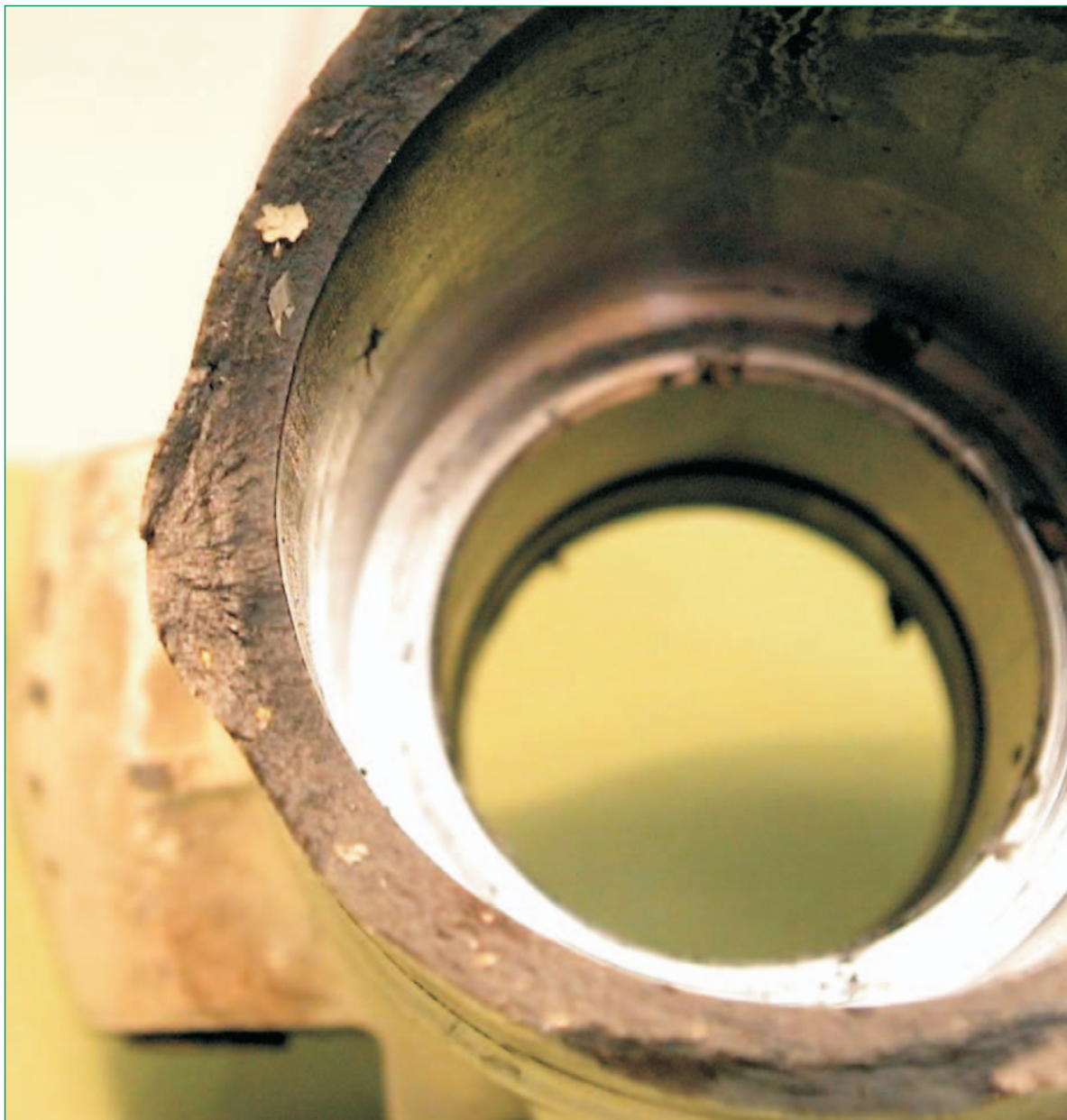
Foto 1. Mitad inferior del «trunnion». Detalle de la rotura. En la parte izquierda está la zona de la nervadura de refuerzo
