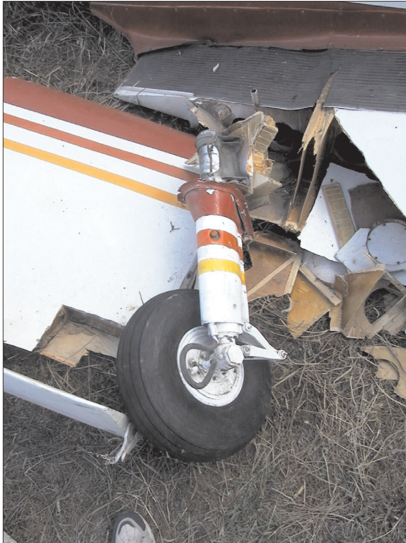
Foto 1. Pata derecha con el amortiguador comprimido
