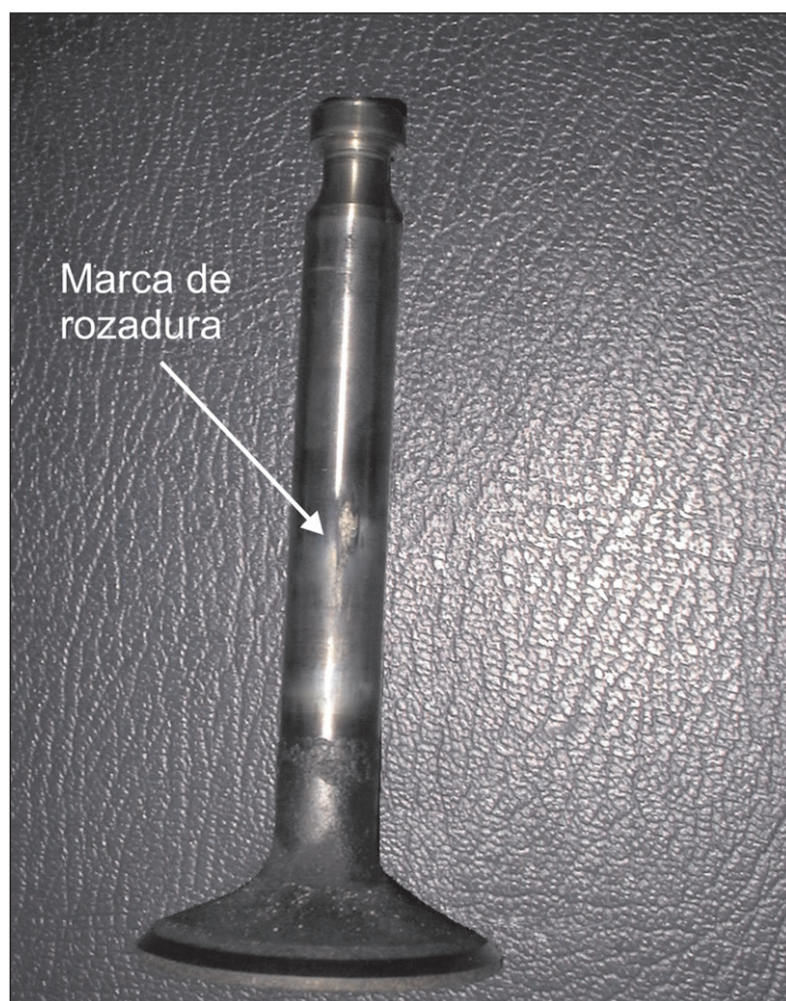
Figura 2. Estado de la válvula
