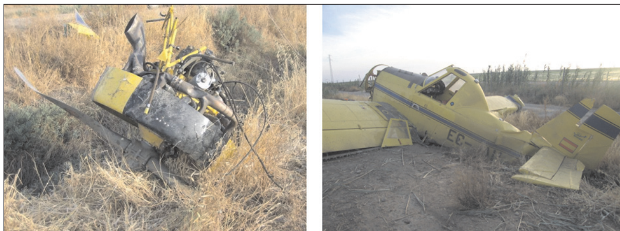
Foto 1. Estado del motor y de la aeronave después del accidente
