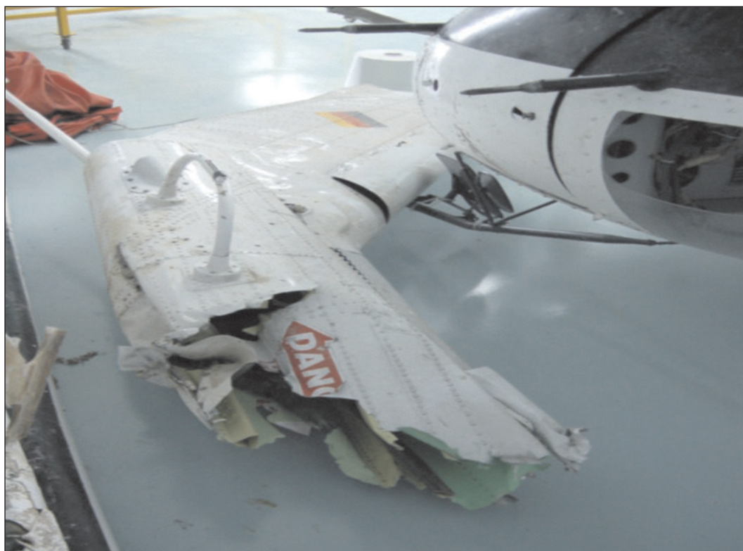
Foto 4. Rotura de la parte final del cono de cola
