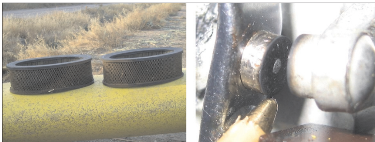
Foto 2. Estado de los filtros y el ruptor de la magneto izquierda
