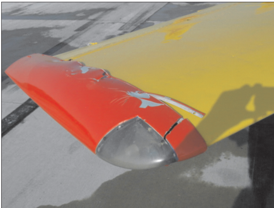
Foto 2. Detalle de daños en el borde marginal del plano izquierdo
