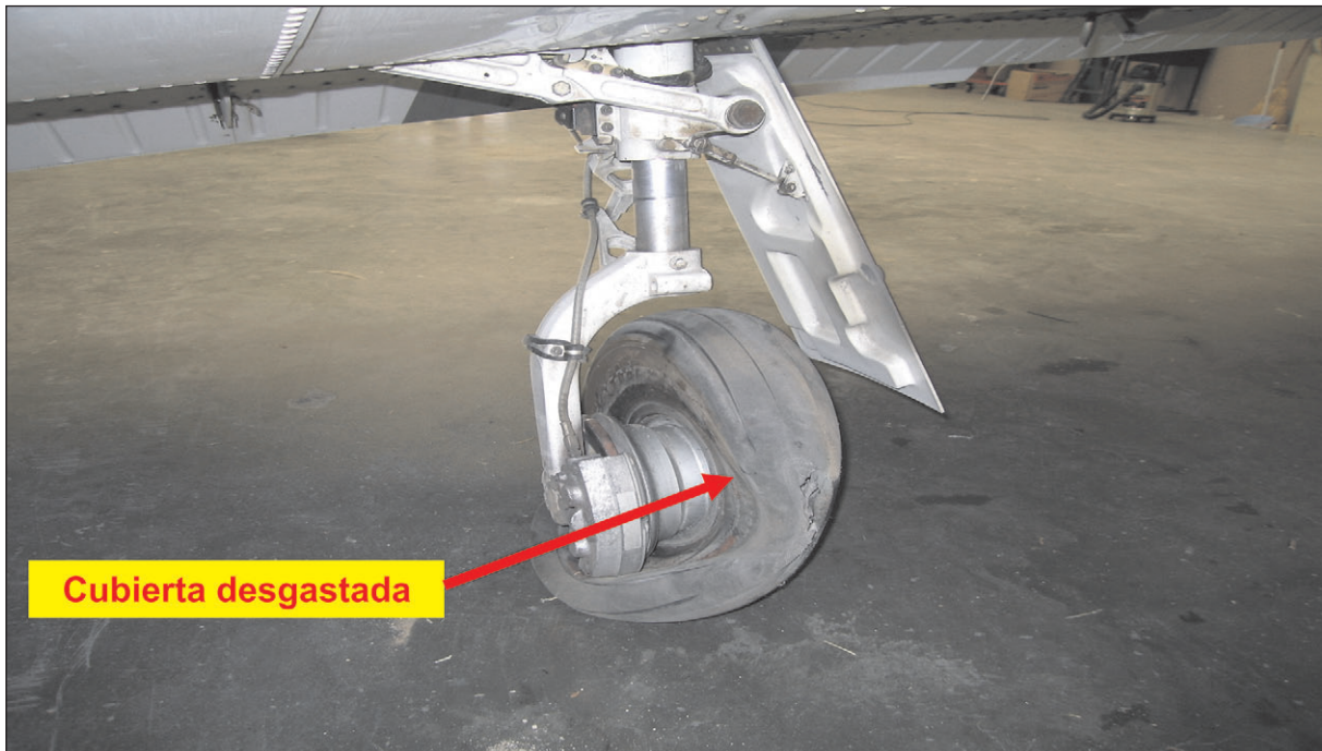
Figura 2. Daños en la pata izquierda
