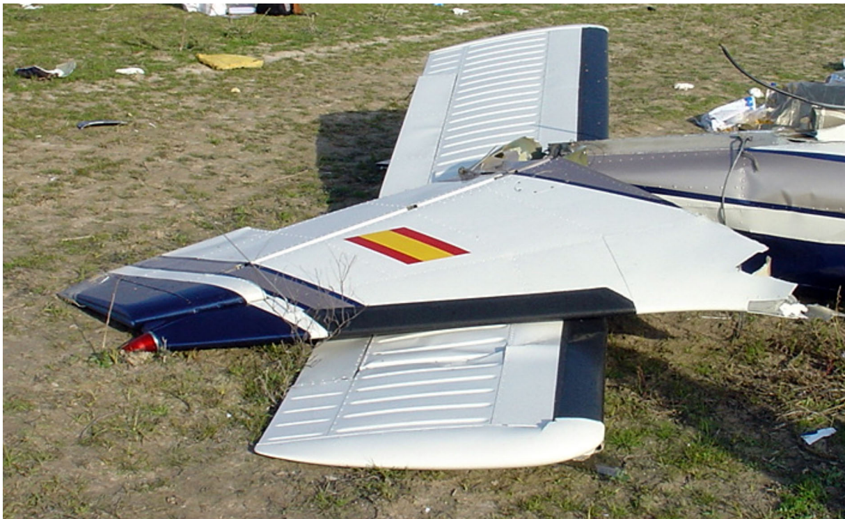
Figura 3. Fotografía de los restos del empanaje de cola del EC-HOL
