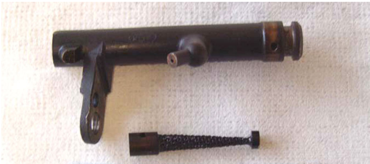
Figura 5. Inyector de aceite del cojinete n.º 2 y filtro del inyector de aceite
