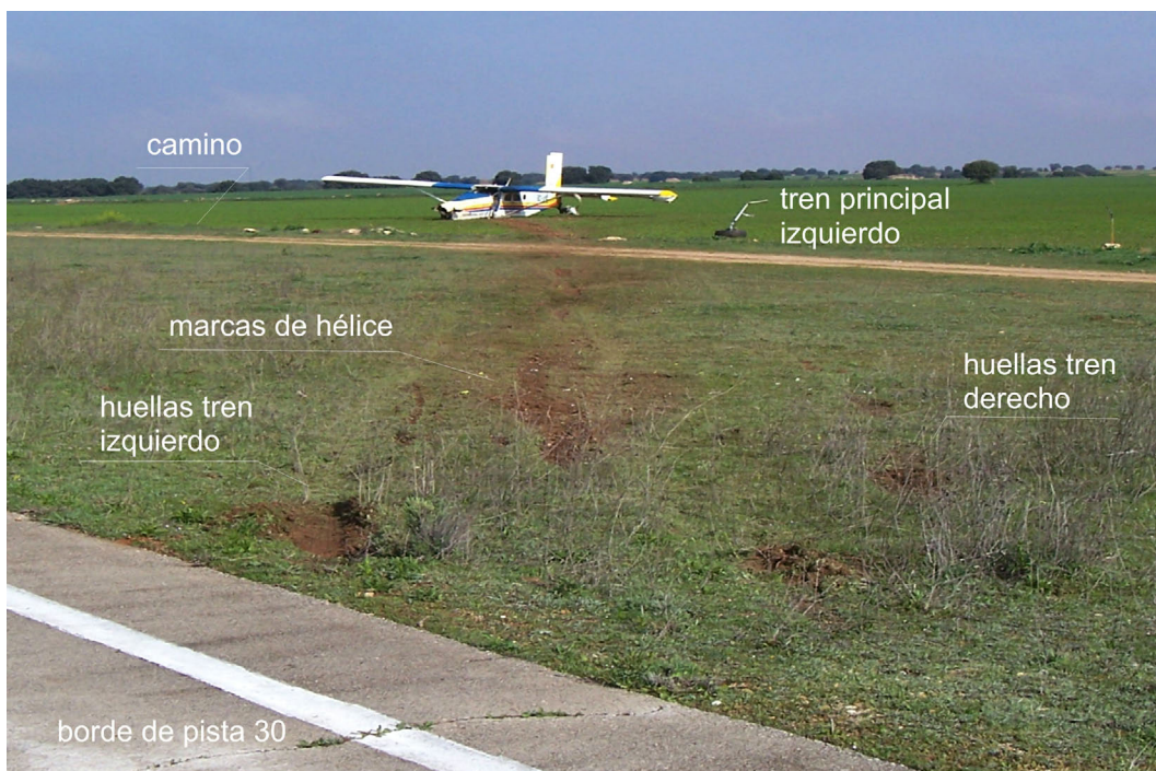
Figura 2. Huellas y posición final de la aeronave
