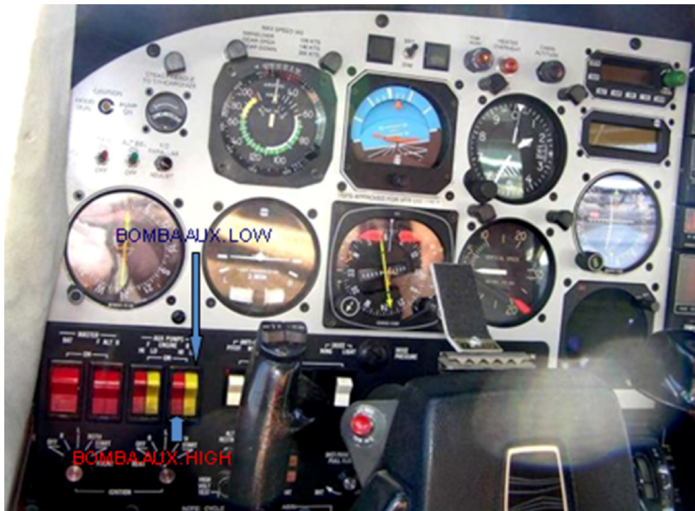
Figura 6. Situación de los interruptores de la bomba eléctrica
