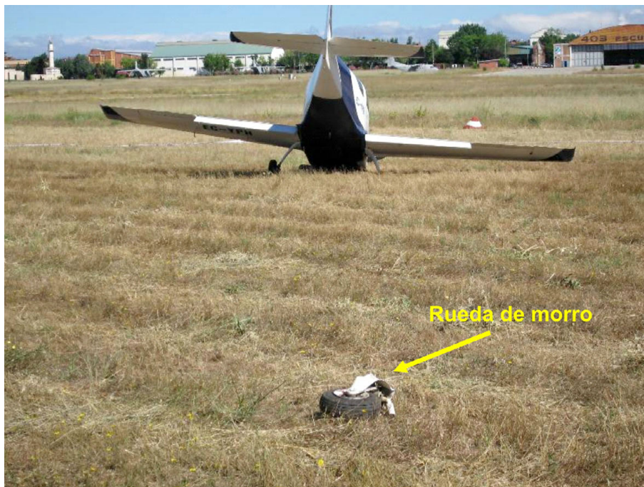
Figura 1. Fotografía de la posición final de la aeronave y la rueda de morro
