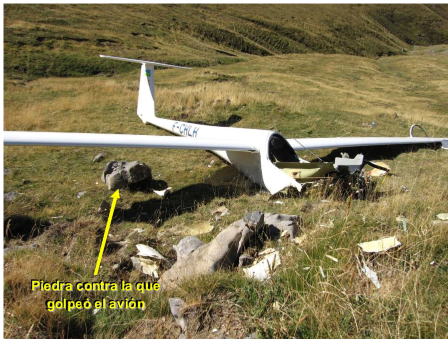
Figura 5. Estado de la aeronave
