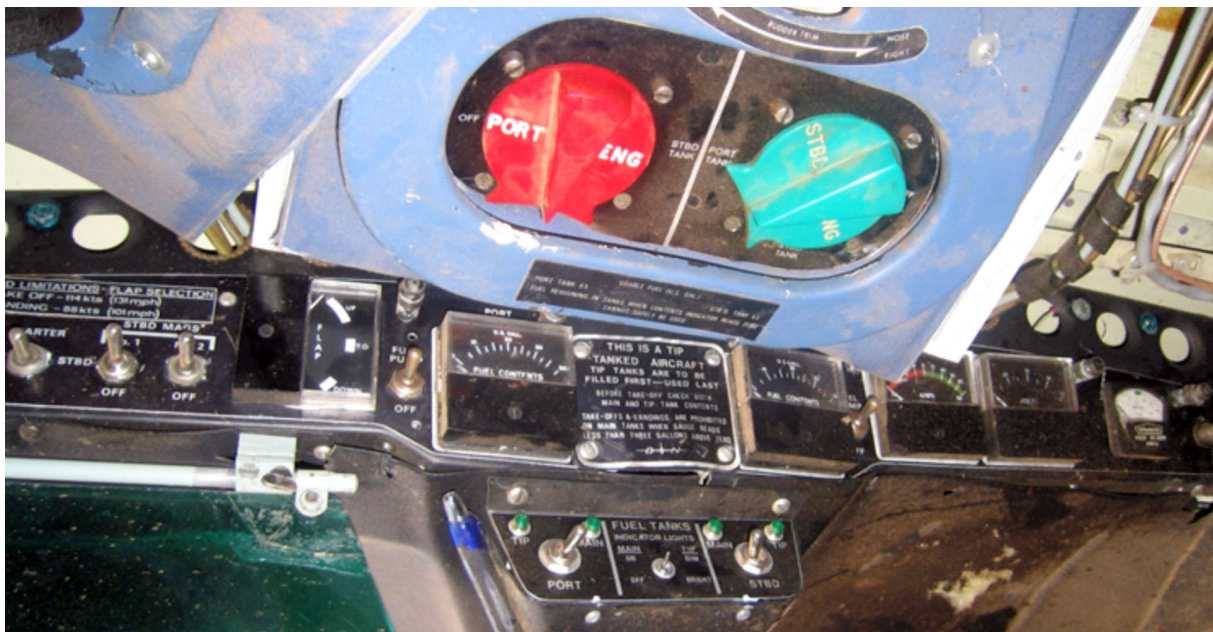
Figura 6. Mandos de las válvulas selectoras de combustible en las posiciones en las que fueron halladas
