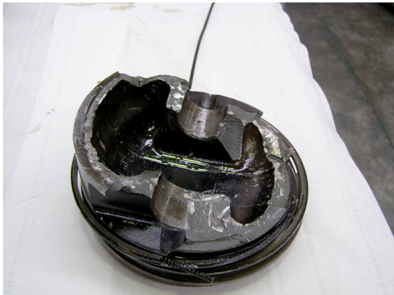
Figura 7. Pistón del cilindro n.º 4
