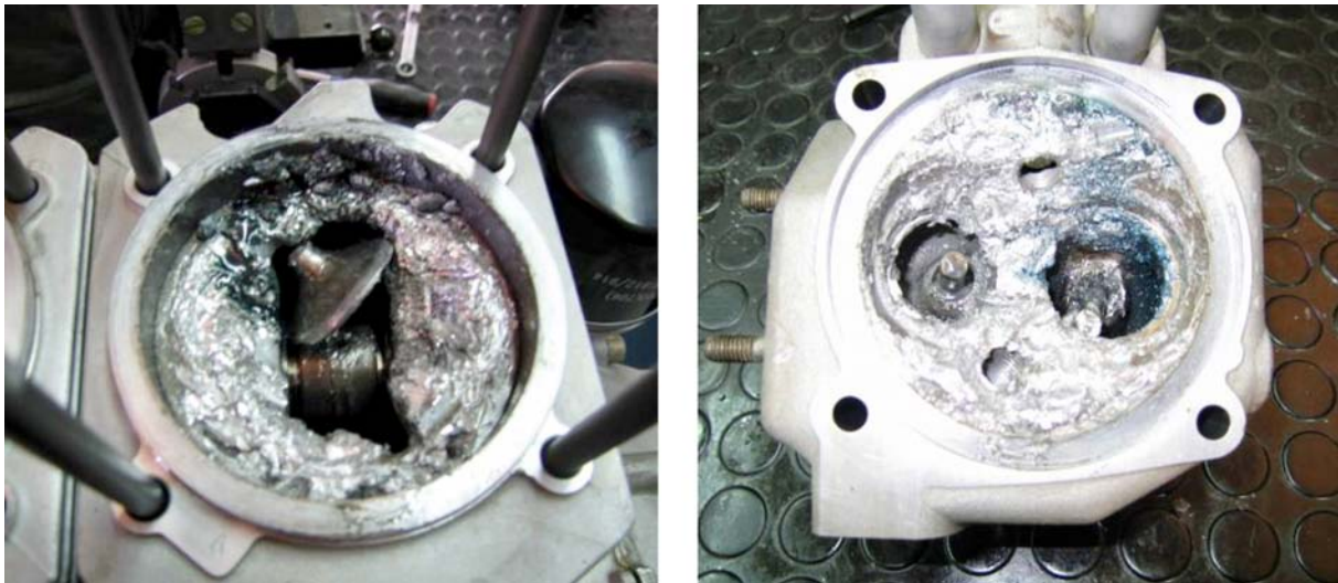
Figura 3. Estado del pistón y de la culata del cilindro n.º 2 durante la inspección
