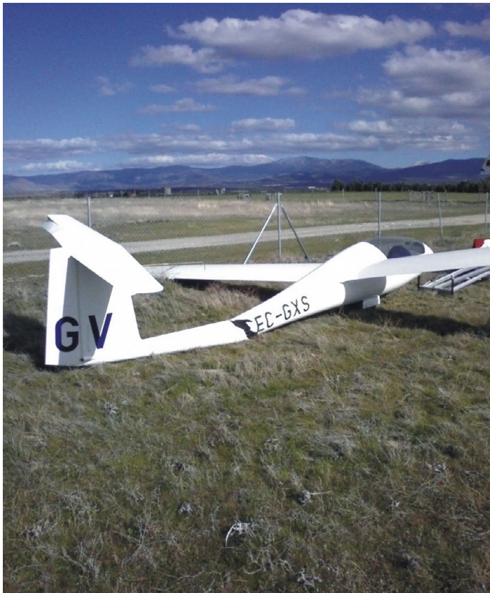
Figura 1. Estado del velero tras el accidente
