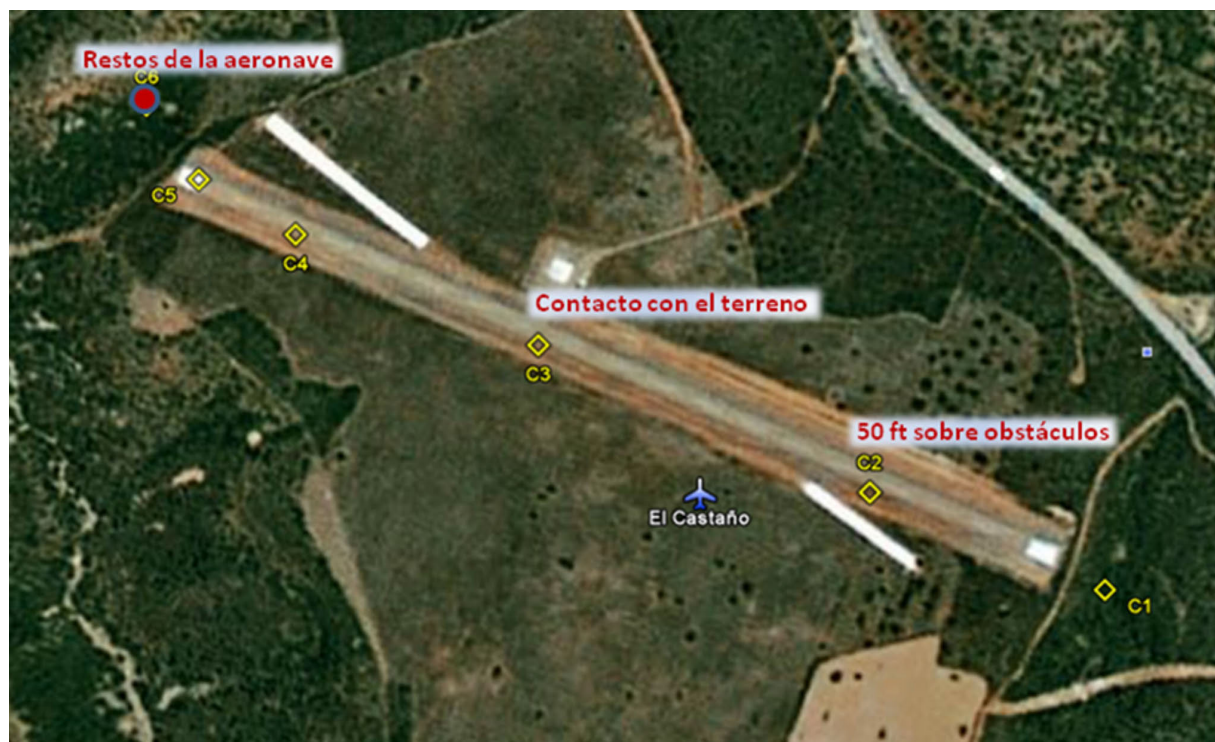
Figura 6. Puntos correspondientes a la trayectoria de aproximación y carrera de aterrizaje
