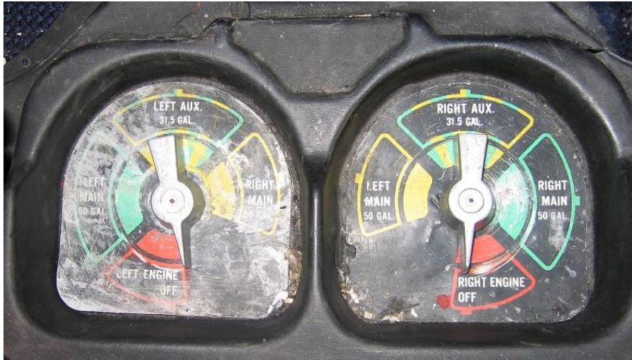
Figura 3. Llaves selectoras de combustible en cabina de una aeronave similar a la del accidente
